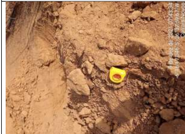
FOTO 14 – Material de 1ª categoria. Solo areno-argiloso, marrom, cascalhoso. Espessura = 0,73 m.
