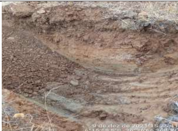
FOTO 48 – Material de 1ª categoria. Solo areno-argiloso-marrom, cascalhoso. Espessura = 0,95 m.
