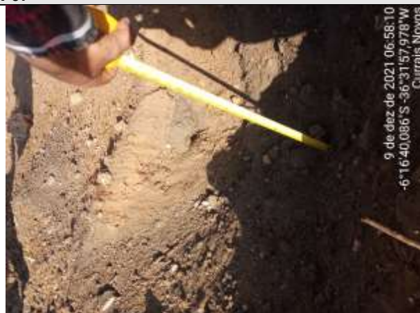
FOTO 08 – Material de 2ª categoria. Solo de alteração areno-argiloso, marrom, com rocha alterada mole na base. Espessura = 0,22 m. Impenetrável aos 0,62 m.
