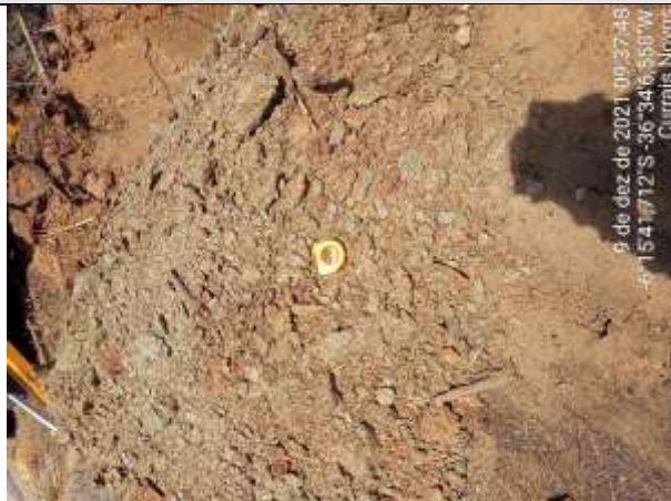
FOTO 25 – Material de 2ª categoria. Solo de alteração areno-siltoso, variegado, gradando para rocha alterada mole. Espessura = 0,30 m. Impenetrável aos 1,10 m.
