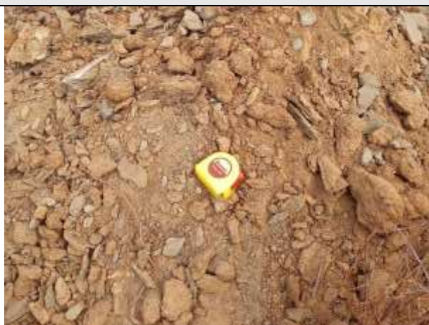
FOTO 40 – Material de 1ª categoria. Aterro nos primeiros 30 cm, recobrindo solo areno-argiloso, marrom, com torrões e fragmentos de rocha. Espessura = 0,81 m.
