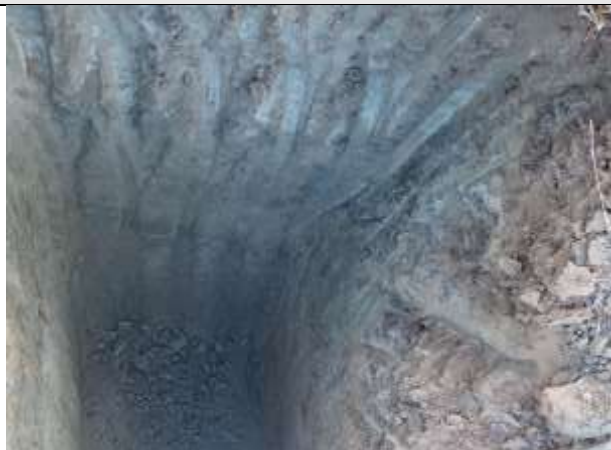
FOTO 50 – Material de 1ª categoria. Solo silto-arenoso, marrom claro, cascalhoso. Espessura = 1,23 m.
