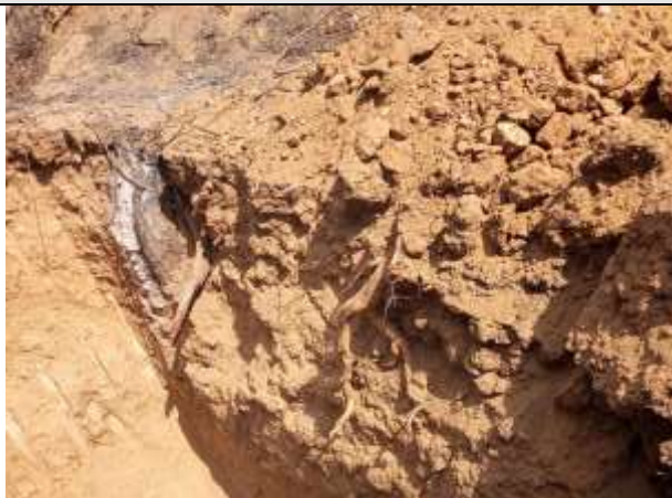
FOTO 22 – Material de 1ª categoria. Solo areno-siltoso, marrom claro. Espessura = 1,60 m.
