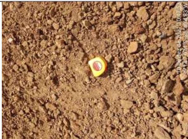
FOTO 73 – Material de 1ª categoria. Solo areno-argiloso, marrom, com cascalho e fragmentos de rocha. Espessura = 1,20 m.
