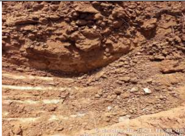
FOTO 32 – Material de 1ª categoria. Solo areno-argiloso, marrom avermelhado, pouco cascalhoso. Espessura = 0,62 m.
