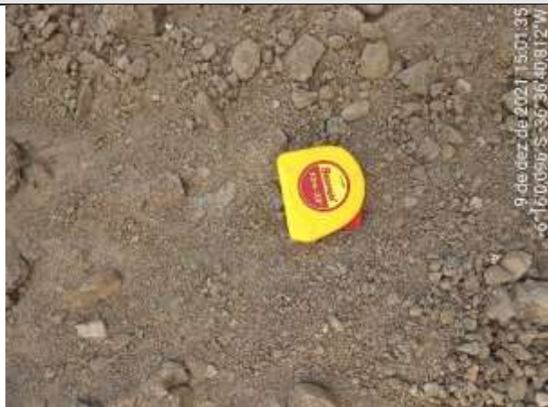
FOTO 44 – Material de 1ª categoria. Areia-argilosa, cascalhosa, marrom claro. Espessura = 1,40 m.
