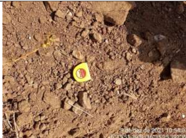
FOTO 35 – Material de 2ª categoria. Solo argilo-arenoso, marrom avermelhado, com fragmentos de rocha e rocha alterada mole na base. Espessura = 0,25 m. Impenetrável aos 1,05 m.
