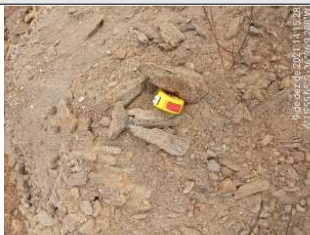
FOTO 41 – Material de 2ª categoria. Solo de alteração areno-argiloso, marrom, com fragmentos de rocha e rocha alterada mole na base. Espessura = 0,59 m. Impenetrável aos 1,40 m.
