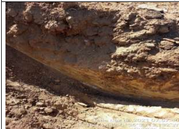
FOTO 16 – Material de 1ª categoria. Solo areno-argiloso, marrom, com cascalho e fragmentos de rocha. Espessura = 0,63 m.
