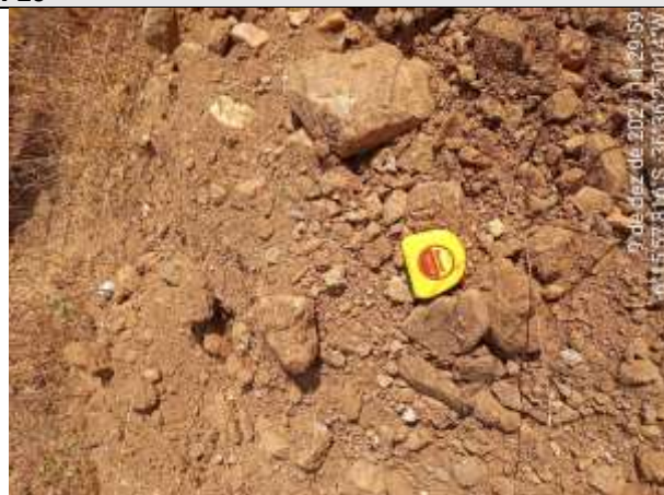
FOTO 43 – Material de 2ª categoria. Solo argilo-arenoso, marrom, com fragmentos de rocha e rocha alterada mole na base. Espessura = 0,26 m. Impenetrável aos 0,90 m.
