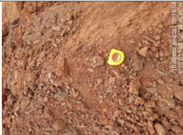
FOTO 64 – Material de 1ª categoria. Solo areno-argiloso, avermelhado, cascalhoso. Espessura = 0,84 m.
