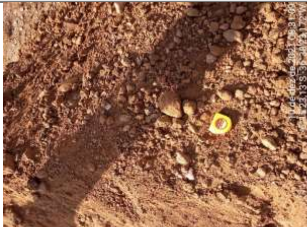
FOTO 60 – Material de 1ª categoria. Solo areno-argiloso, marrom avermelhado, cascalhoso. Espessura = 1,65 m.
