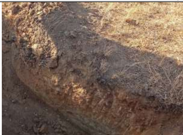
FOTO 52 – Material de 1ª categoria. Solo areno-argiloso a silto-argiloso, cascalhoso, marrom a alaranjado. Espessura = 0,61 m.
