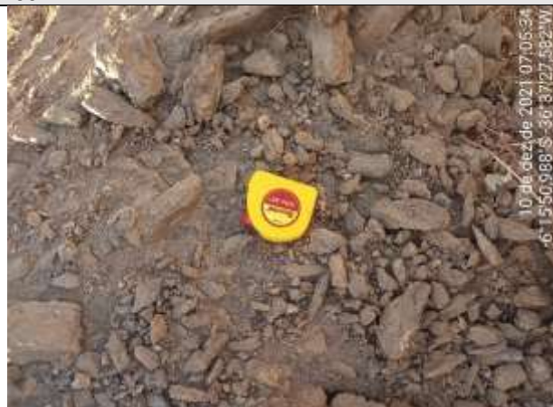
FOTO 53 – Material de 2ª categoria. Solo de alteração silto-argiloso, cinza claro, com rocha alterada mole na base. Espessura = 0,22 m. Impenetrável aos 0,83 m.
