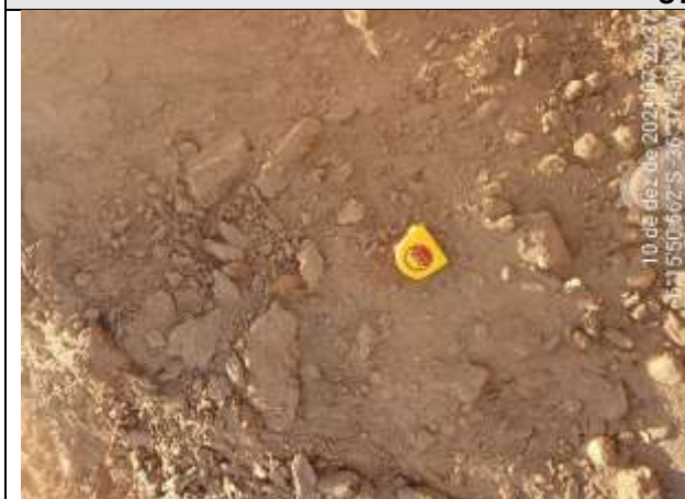
FOTO 54 – Material de 1ª categoria. Solo areno-argiloso a silto-argiloso, com cascalho e fragmentos de rocha, marrom a alaranjado. Espessura = 0,95 m.
