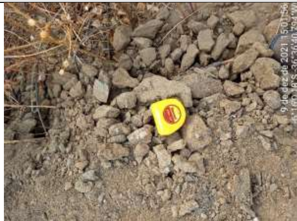
FOTO 45 – Material de 2ª categoria. Solo silto-argiloso, marrom claro, com cascalho e torrões. Atingiu 2,00 m de profundidade antes de alcançar o impenetrável, paralisando a esta profundidade.
