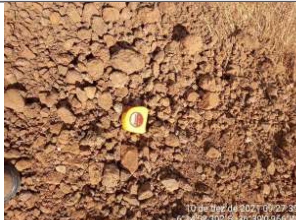
FOTO 67 – Material de 2ª categoria. Solo argilo-arenoso, alaranjado, cascalhoso, com torrões. Espessura = 0,25 m. Impenetrável aos 0,60 m.
