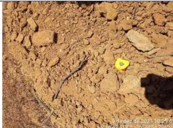
FOTO 31 – Material de 2ª categoria. Solo argilo arenoso, marrom claro, com fragmentos de rocha e rocha alterada mole na base. Espessura = 0,50 m. Impenetrável aos 1,40 m.
