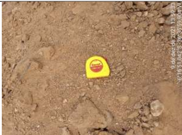
FOTO 38 – Material de 1ª categoria. Solo areno-argiloso, marrom, cascalhoso. Espessura = 1,05 m.
