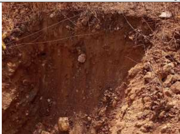
FOTO 42 – Material de 1ª categoria. Solo areno-argiloso, marrom avermelhado, com fragmentos de rocha. Espessura = 0,64 m.
