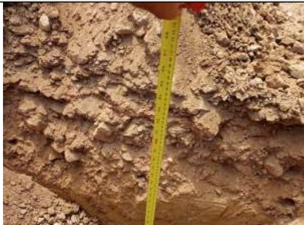
FOTO 36 – Material de 1ª categoria. Solo areno-argiloso, marrom, cascalhoso. Espessura = 1,12 m.
