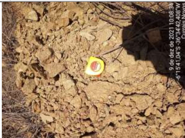
FOTO 29 – Material de 2ª categoria. Rocha alterada mole, variegada, com fragmentos de rocha. Espessura = 0,12 m. Impenetrável aos 0,75 m.
