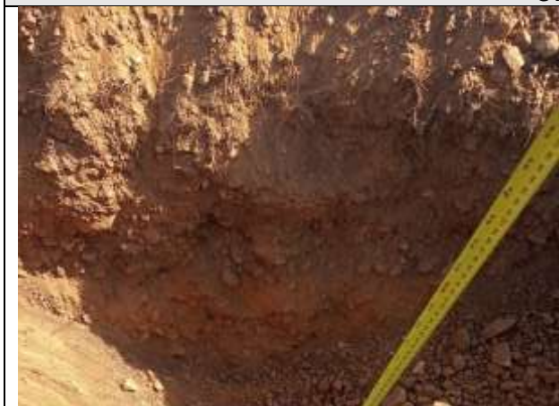
FOTO 56 – Material de 1ª categoria. Solo areno-argiloso, marrom escuro, cascalhoso. Espessura = 0,82 m.
