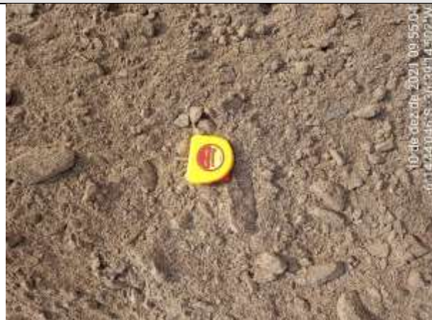
FOTO 69 – Material de 2ª categoria. Solo silto-argiloso, cascalhoso, cinza amarelado, com fragmentos de rocha. Atingiu 2,00 m de profundidade antes de alcançar o impenetrável, paralisando a esta profundidade.
