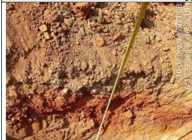
FOTO 58 – Material de 1ª categoria. Solo areno-siltoso, pouco argiloso, marrom claro com nível avermelhado, cascalhoso. Espessura = 1,25 m.
