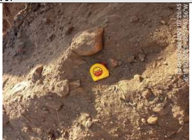
FOTO 55 – Material de 2ª categoria. Solo de alteração silto-argiloso, marrom claro, com fragmentos de rocha. Espessura = 1,05 m. Impenetrável aos 2,00 m.
