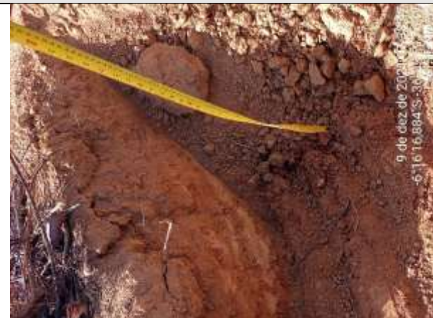
FOTO 15 – Material de 2ª categoria. Solo argilo-arenoso, marrom claro, com cascalho e fragmentos de rocha. Espessura = 0,33 m. Impenetrável aos 1,06 m.
