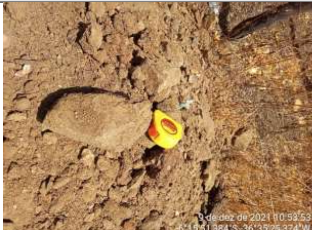
FOTO 34 – Material de 1ª categoria. Solo areno-argiloso, marrom, com fragmentos de rocha. Espessura = 0,80 m.
