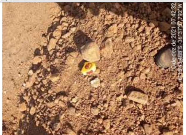
FOTO 57 – Material de 2ª categoria. Solo silto-argiloso, marrom avermelhado, com fragmentos de rocha e rocha alterada mole na base. Espessura = 0,28 m. Impenetrável aos 1,10 m.
