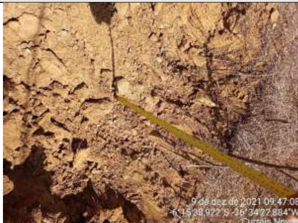
FOTO 27 – Material de 2ª categoria. Solo de alteração silto-arenoso, marrom claro com fragmentos de rocha. Espessura = 0,29 m. Impenetrável aos 0,89 m.
