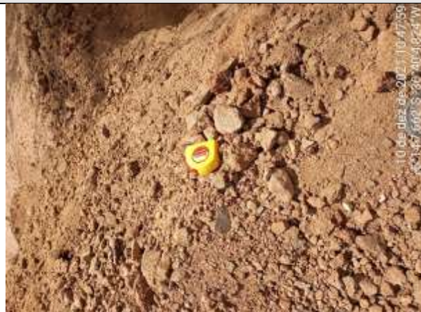
FOTO 74 - Material de 2ª categoria. Solo de alteração areno-argiloso a argilo-arenoso, marrom claro, com fragmentos de rocha e rocha alterada mole na base. Espessura = 0,50 m. Impenetrável aos 1,70 m.
