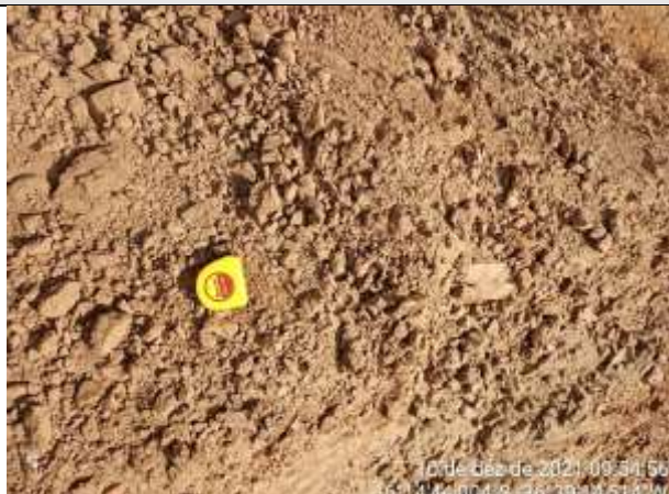
FOTO 68 – Material de 1ª categoria. Solo silto-arenoso, cascalhoso, marrom claro, com fragmentos de rocha. Espessura = 1,55 m.
