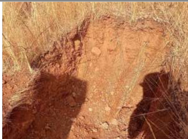
FOTO 62 – Material de 1ª categoria. Solo areno-argiloso, avermelhado, cascalhoso. Espessura = 0,38 m.
