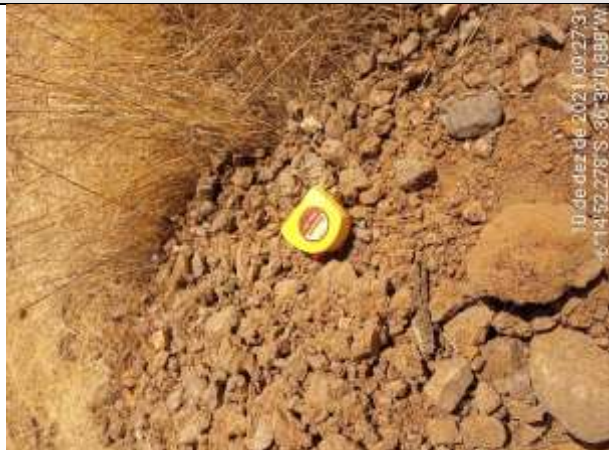
FOTO 66 – Material de 1ª categoria. Solo areno-argiloso, marrom alaranjado, com cascalho e fragmentos de rocha. Espessura = 0,35 m.
