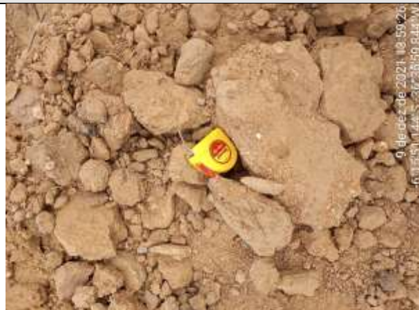
FOTO 39 – Material de 2ª categoria. Solo areno-argiloso, marrom, com cascalho e fragmentos de rocha. Espessura = 0,35 m. Impenetrável aos 1,40 m.
