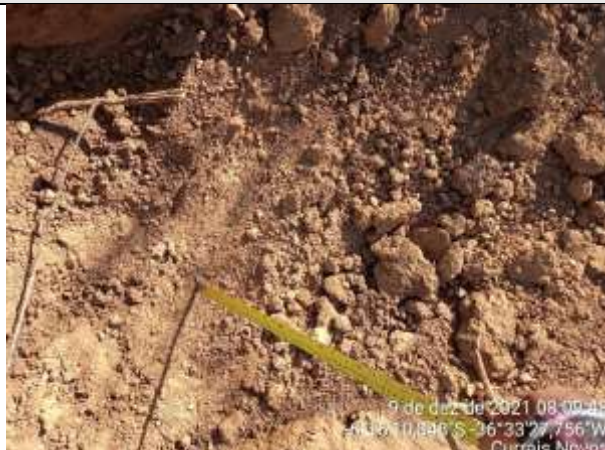
FOTO 19 – Material de 2ª categoria. Solo de alteração argil-arenoso, pouco siltoso, pouco cascalhoso, marrom claro. Espessura = 0,22 m. Impenetrável aos 0,62 m.
