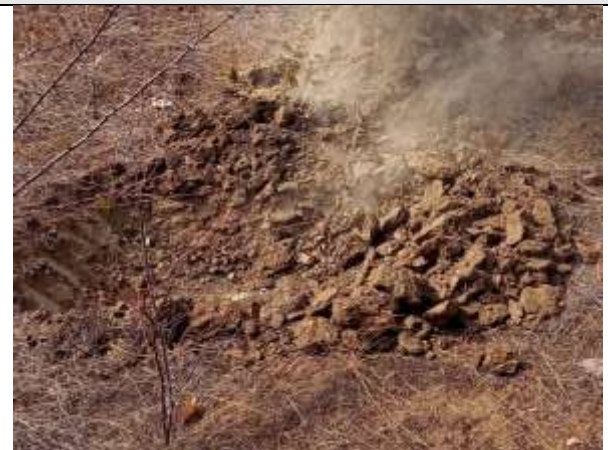
FOTO 20 – Material de 1ª categoria. Solo silto-argiloso, marrom, pouco cascalhoso. Espessura = 1,20 m.
