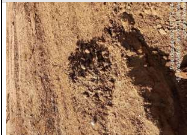
FOTO 09 – Material de 1ª categoria. Solo de alteração areno-argiloso, marrom. Espessura = 0,46 m.
