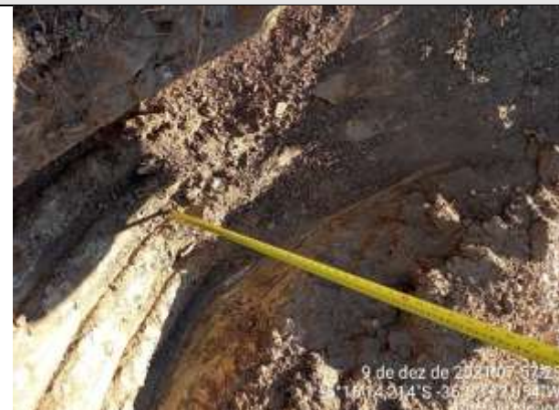
FOTO 17 – Material de 2ª categoria. Solo de alteração argilo-arenoso, marrom claro, cascalhoso. Espessura = 0,49 m. Impenetrável aos 1,12 m.
