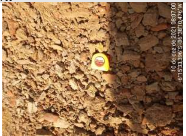
FOTO 59 – Material de 2ª categoria. Solo de alteração silto-argiloso, marrom claro, com cascalho e torrões. Espessura = 0,35 m. Impenetrável aos 1,60 m.
