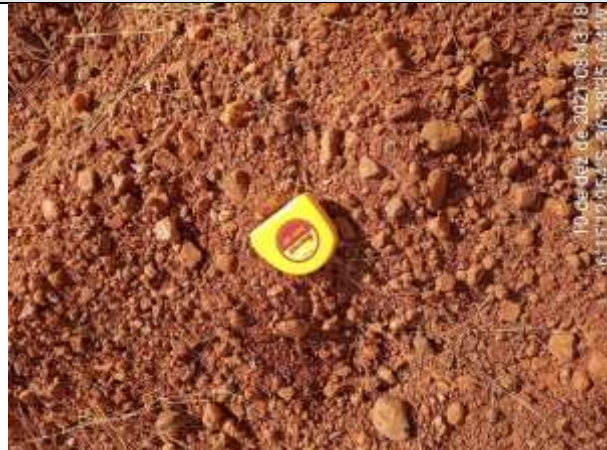
FOTO 63 – Material de 2ª categoria. Solo silto-argiloso a argilo-siltoso, avermelhado, com cascalho e fragmentos de rocha. Espessura = 0,32 m. Impenetrável aos 0,70 m.
