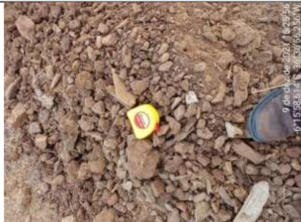
FOTO 49 – Material de 2ª categoria. Rocha alterada mole gradando para rocha alterada dura. Espessura = 0,25 m. Impenetrável aos 1,20 m.
