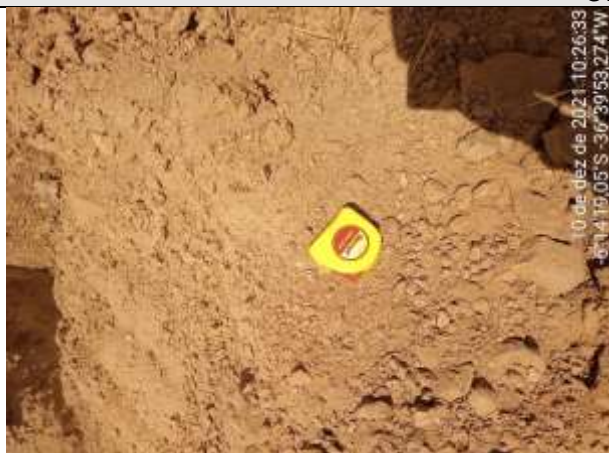
FOTO 71 – Material de 1ª categoria. Solo areno-siltoso, marrom claro, cascalhoso. Espessura = 0,42 m.
