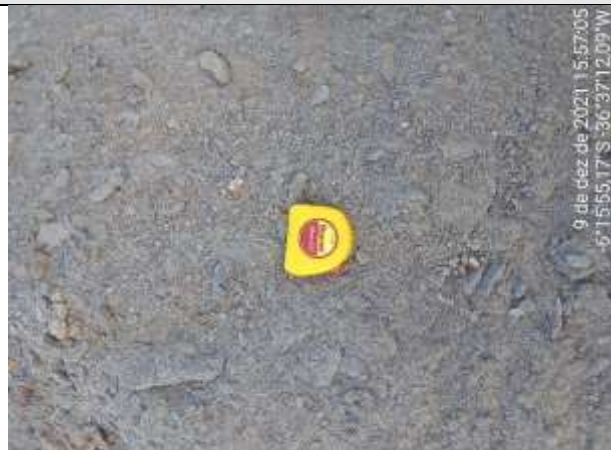
FOTO 51 – Material de 2ª categoria. Solo de alteração silto-argiloso, cinza claro, com rocha alterada mole na base. Espessura = 0,57 m. Impenetrável aos 1,80 m.
