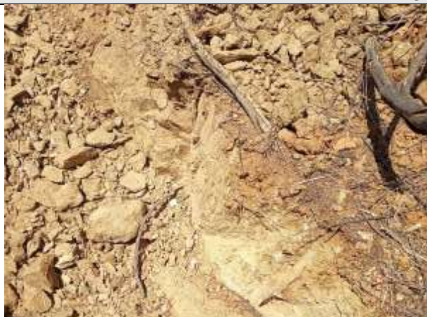
FOTO 28 – Material de 1ª categoria. Solo de alteração areno-siltoso, marrom, com fragmentos de rocha. Espessura = 0,63 m.
