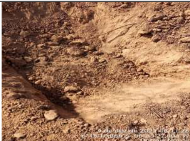
FOTO 18 – Material de 1ª categoria. Solo argilo-arenoso, marrom claro, pouco cascalhoso. Espessura = 0,40 m.
