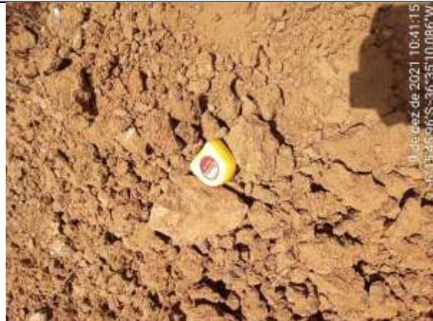
FOTO 33 – Material de 2ª categoria. Solo de alteração argilo-arenoso, marrom, com fragmentos de rocha. Espessura = 0,27 m. Impenetrável aos 0,89 m.
