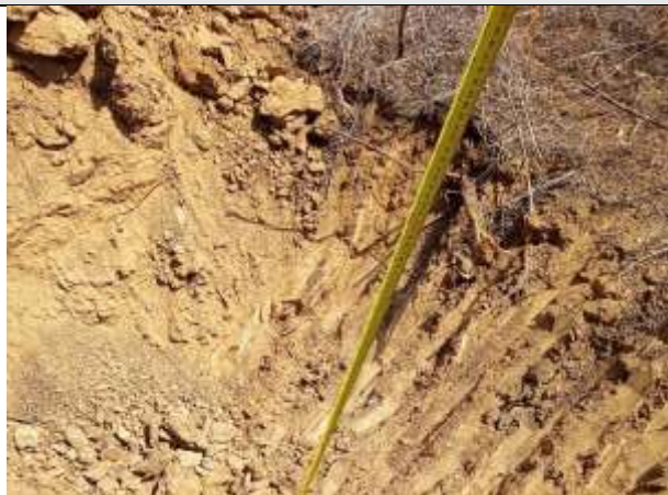
FOTO 26 – Material de 1ª categoria. Solo areno-siltoso, cascalhoso, marrom claro. Espessura = 0,60 m.
