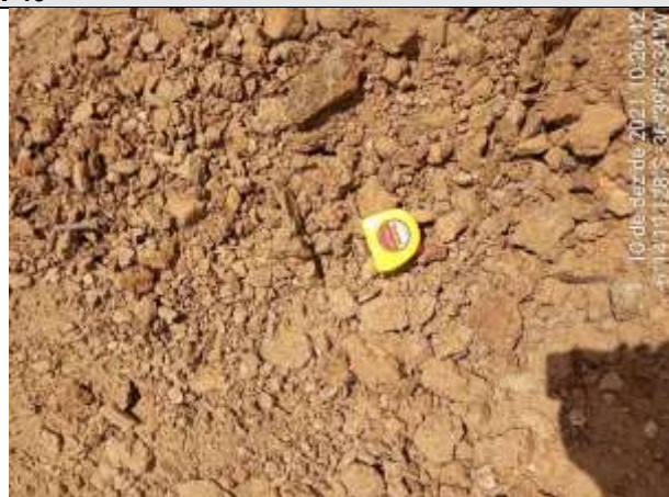
FOTO 72 – Material de 2ª categoria. Solo de alteração areno-argiloso a argilo-arenoso, marrom, com cascalho e rocha alterada mole na base. Espessura = 0,63 m. Impenetrável aos 1,05 m.
